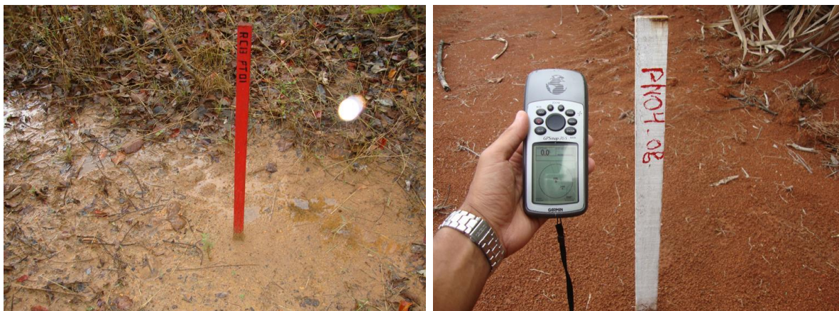
Figura 12: Exemplos de estaqueamentos provenientes de locação topográfica de projetos hidroambientais
